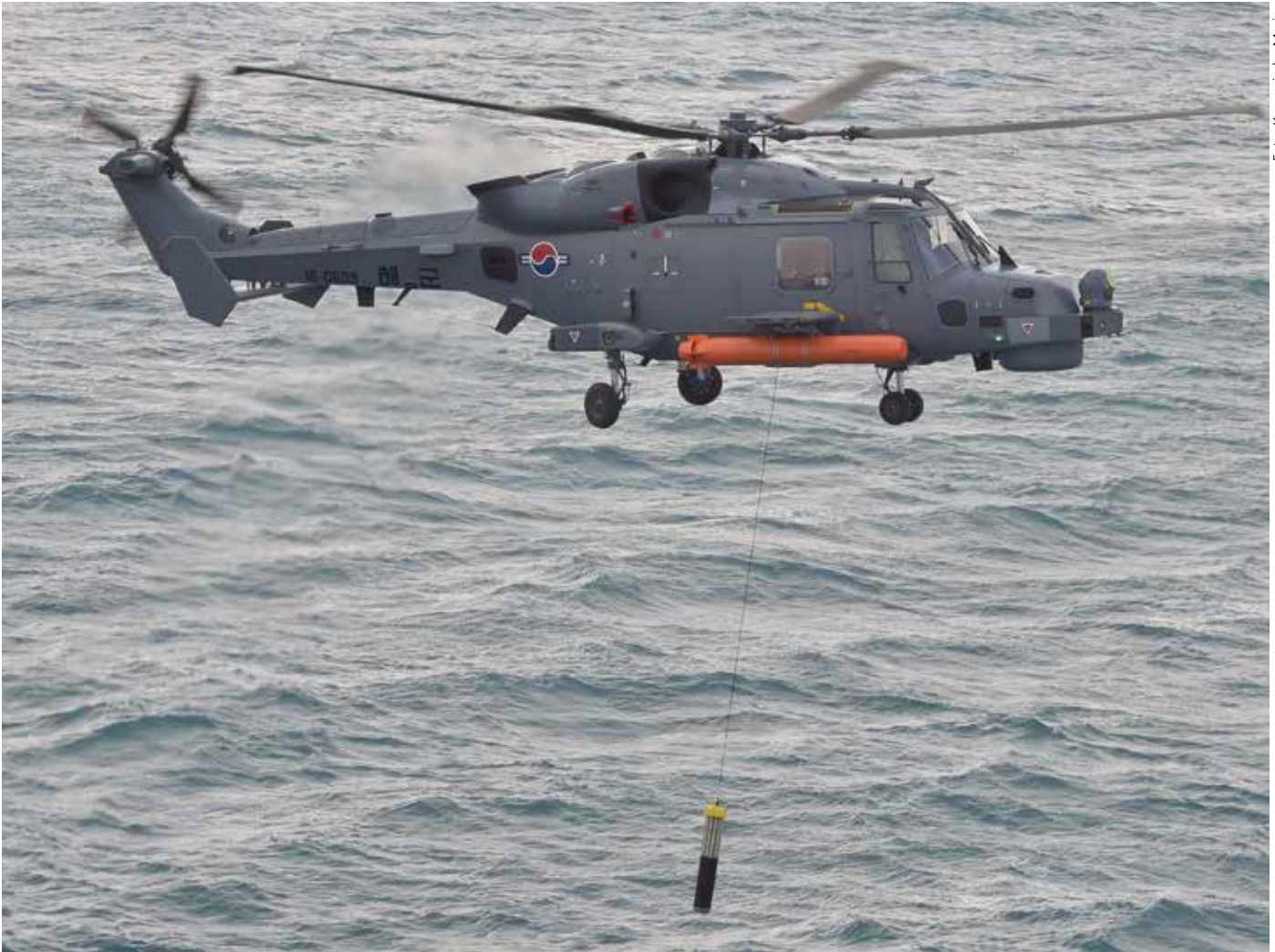
Eine AW159 Wildcat der südkoreanischen Marine beim Einsatz eines FLASH-Tauchsonars von Thales
