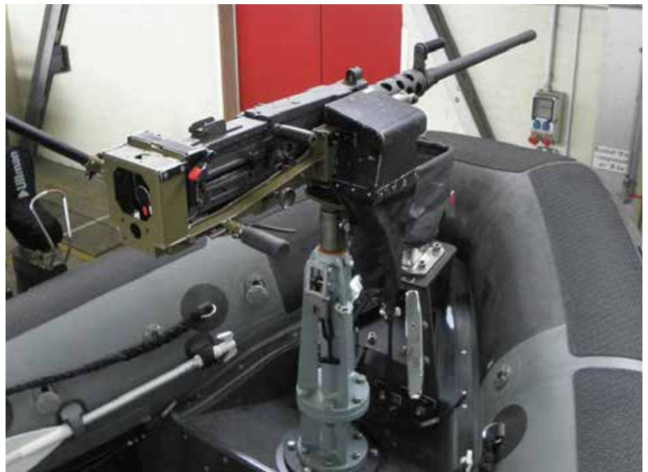
Eingerüstetes Maschinengewehr im Bug
