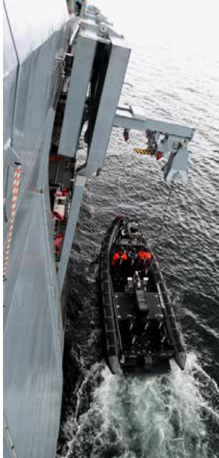
Buster im Schlepp an der Fangleine mit angeschlagener Heißleine
