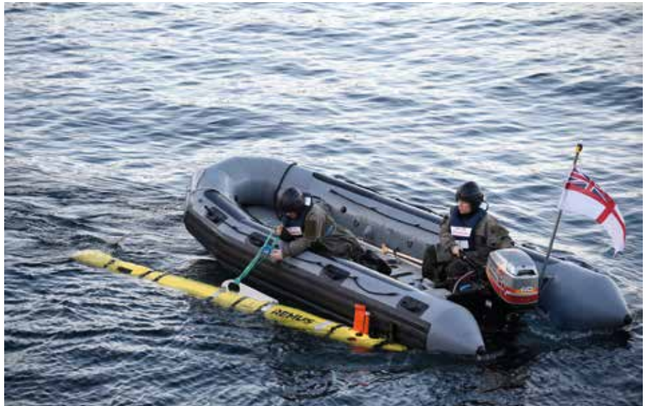
Britische Matrosen setzen im Rahmen der multinationalen Übung Unmanned Warrior ein REMUS 600 UUV aus. Die REMUS Drohnen (Remote Environmental Monitoring Units) wurden am Meeresforschungsinstitut Woods Hole (Massachusetts) entwickelt und werden durch Kongsberg (Norwegen) hergestellt. REMUS 600 UUV wird zwecks Aufklärung und Minenkämpfung eingesetzt. Quelle: US-Navy.
