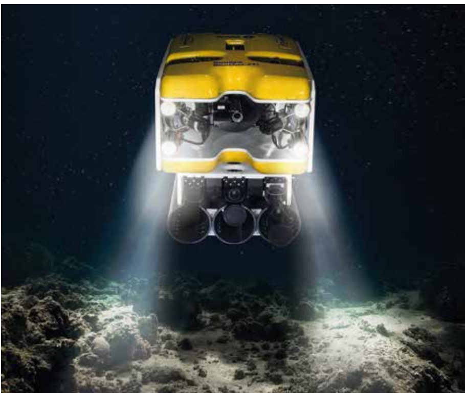
Das von SAAB angebotene MUMNS System zerstört Minen und andere Sprengkörper, ohne die Drohne zu gefährden. Quelle: SAAB
