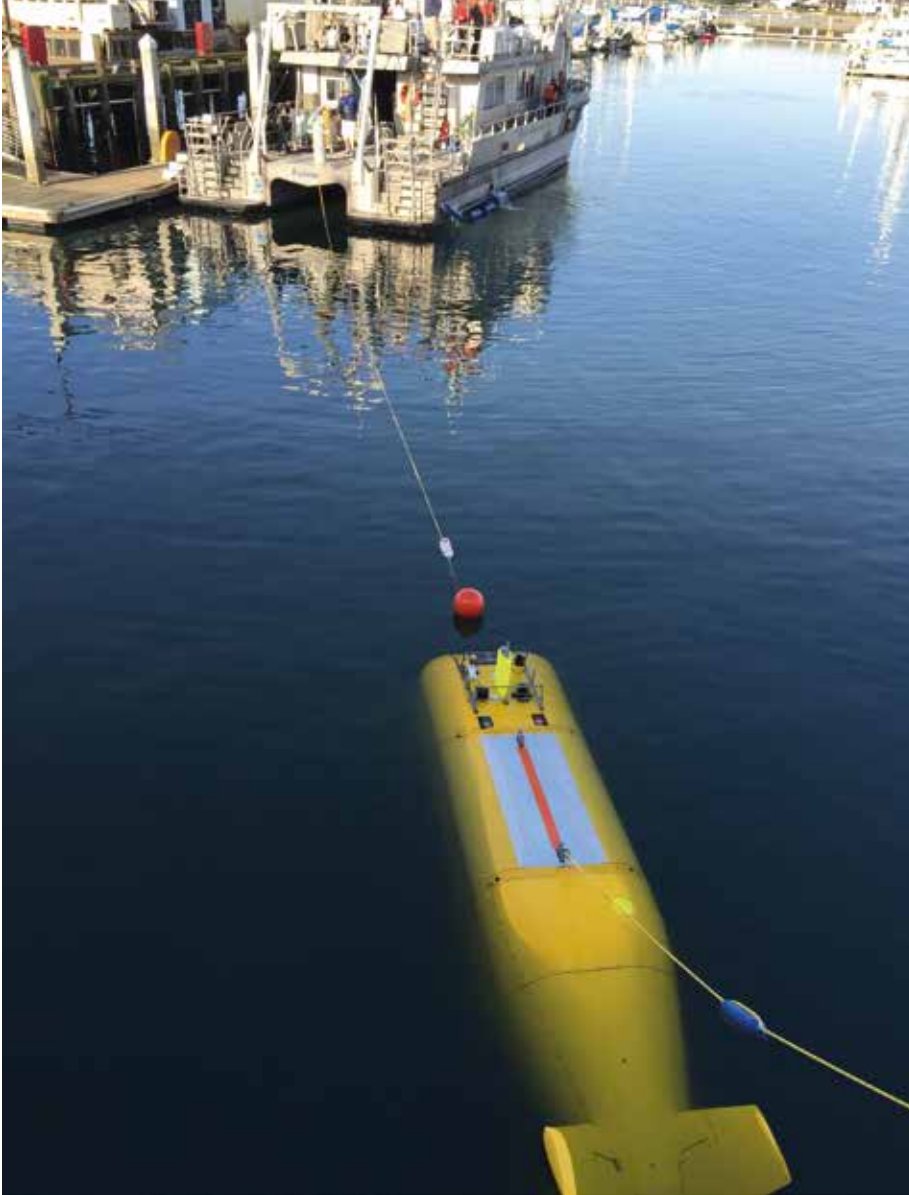
Das von Boeing entwickelte Echo Ranger UUV entspricht von der Größe und der Verdrängung her dem von der US-Navy angestrebten LDUUV-Konzept. Quelle: NOAA
