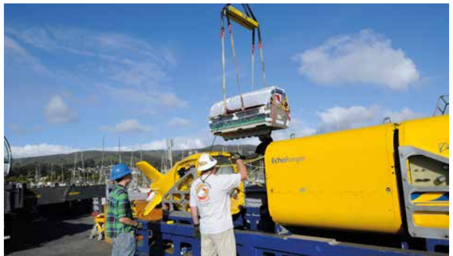
Austausch der Lithium-Polymer Batteriemodule des Echo Ranger UUVs. Das von Boeing entwickelte autonome UUV entspricht im Ausmaß dem LDUUV-Konzept. Quelle: NOAA
