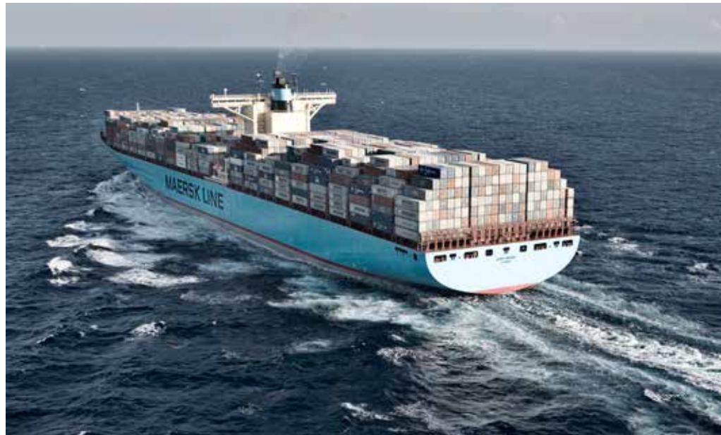
Abb 5: Befährt die Route Shanghai-Danzig: EMMA MÆRSK, Containerschiff mit 14.770 TEU. 397,71 m lang (Lüa), 56,40 m breit und maximaler Tiefgang 16,50 m. (Foto: Mærsk)
