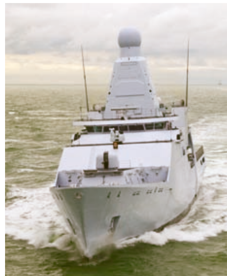
I-MAST 400, eingee- rüstet auf Hochsee- Patrouillenbooten der HOLLAND-Klasse der Königlichen Niederländischen Marine. Foto: Thales
