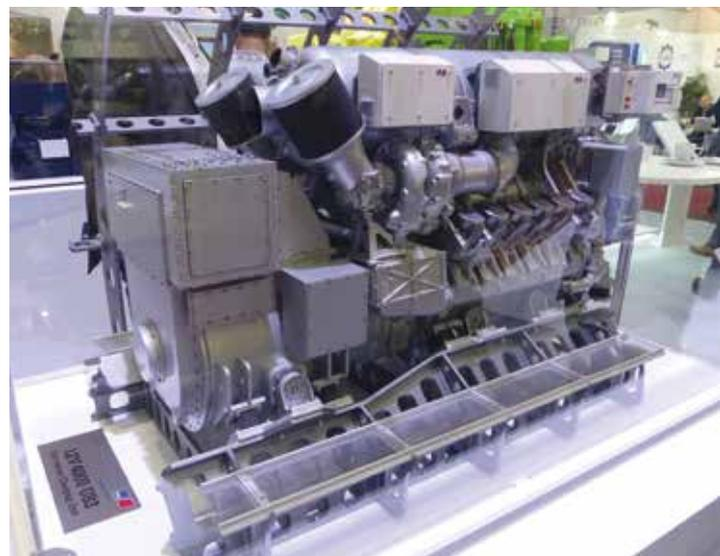
Das Dieselaggregat für U-Boote von MTU im Modell (Foto: Karr)
